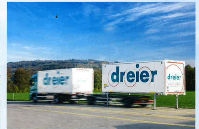
Lastwagen mit Aufbau, für den Transport von Wechselbrücken eingerichtet. Apropos – Dreier setzt stark auf Wechselbrückenanhängerzüge.
